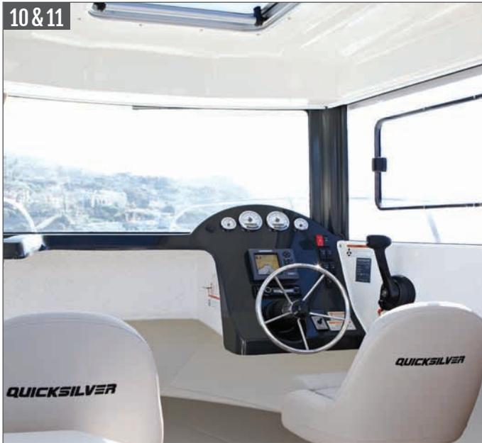
Tableau de bord avec direction hydraulique, et emplacement prévu pour GPS/Traceur de cartes 7", stéréo
