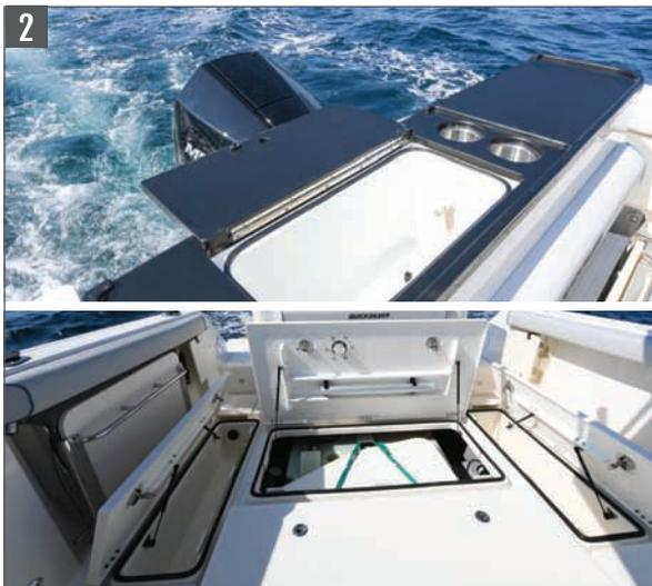
Meilleurs équipements de pêche de sa catégorie: station de pêche incluant vivier, table à découper, grands bacs à poissons avec eau oxygénée, système de lavage eau de mer, porte cannes, barres de maintien bâbord tribord, rangements de cannes dans cockpit et cabine
